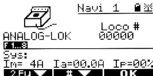
NOTE : L'utilisation une locomotive analogique peut engendrer un sifflement à haute fréquence provoqué par l'envoi des signaux numériques. Ce « sifflement » ne provoque pas de dommage à l'électronique des locomotives concernées.
