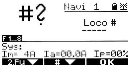
**NOTE :** La gestion des données relatives aux locomotives est effectuée par la centrale digitale. Si une locomotive est choisie, la centrale digitale l'enregistrera comme réservée et elle ne pourra pas être choisie par les autres navigateurs. Néanmoins, si une locomotive ne se déplace pas, elle sera considérée comme déconnectée et pourra être sélectionnée. Le nombre des locomotives actives est affiché en permanence dans le coin droit supérieur de l'écran digital de la Centrale.
